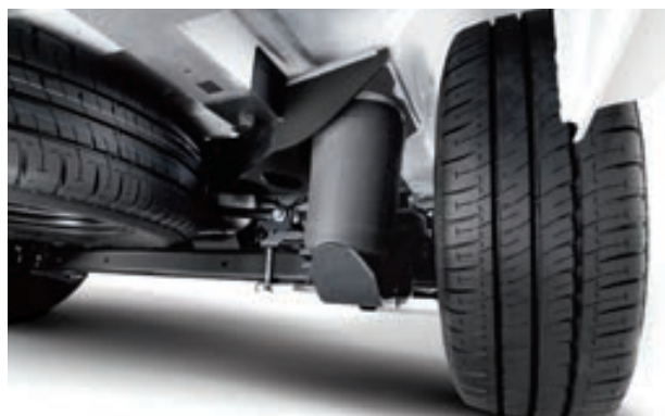
PNEUMATINĖ PAKABA* užtikrina didesnę komfortą ir prošvaisą nepriklausomai nuo apkrovos.
