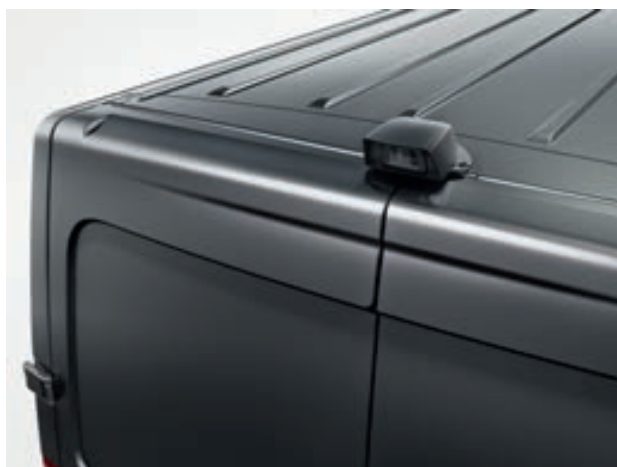
3 GALINIO VAIZDO KAMERA ant stogo įtaisyta kamera pakeičia veidrodį ir padeda manevruoti atbuline eiga.
